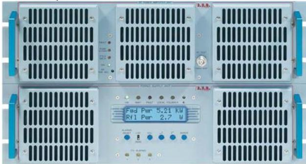
*Gambar. Perangkat Power Amplifier RVR*
